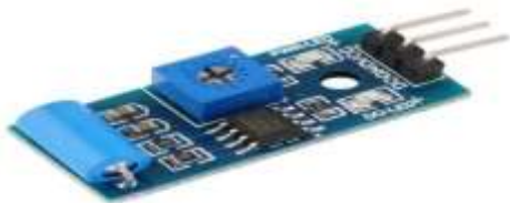
Fig: vibration sensor
