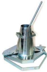
Fig.4.1 Slump Cone Apparatus
